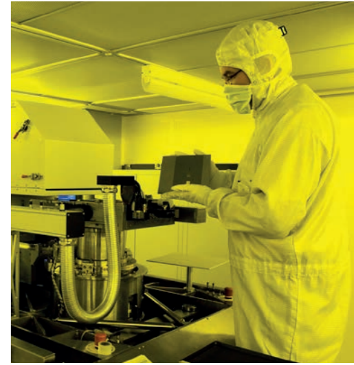
Die Glasmaßstäbe, die über Genauigkeiten im Mikrometer-Bereich verfügen, werden in der Teilerei gefertigt. Die präzisen Fertigungsprozesse stellen sehr hohe Anforderungen an Qualität und Zuverlässigkeit der Reinraumtechnik.
