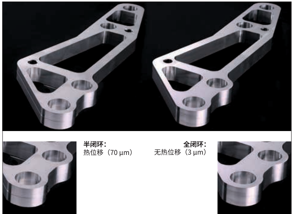
图5 连接杆，从毛坯开始加工两次
