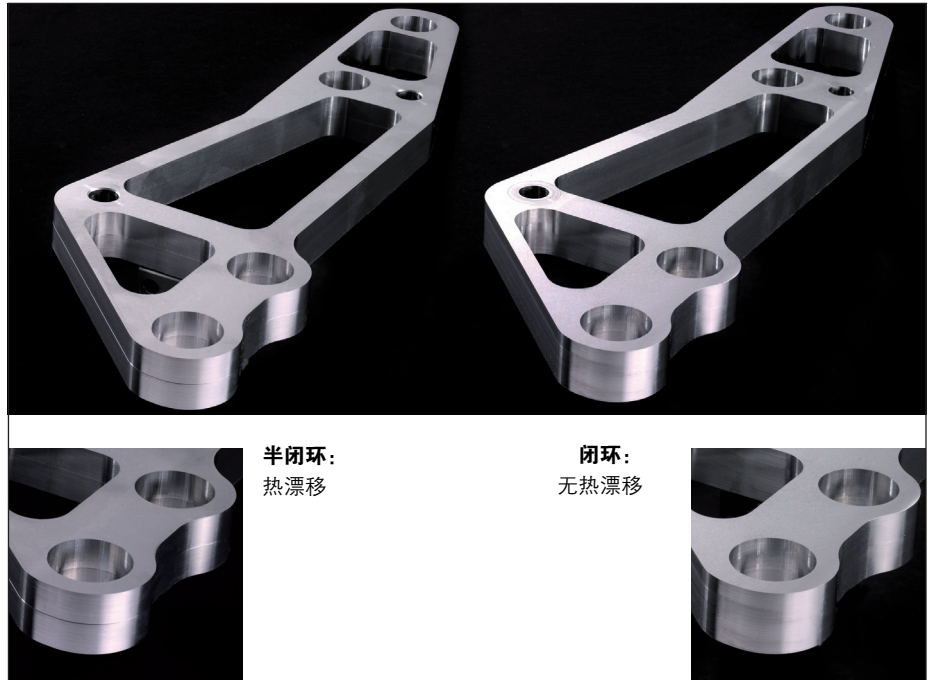
图6： 连杆，一个毛坯加工两次
